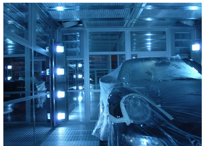
Abb. 26 Kombikabine in Spezialausführung mit UV-Strahlern
